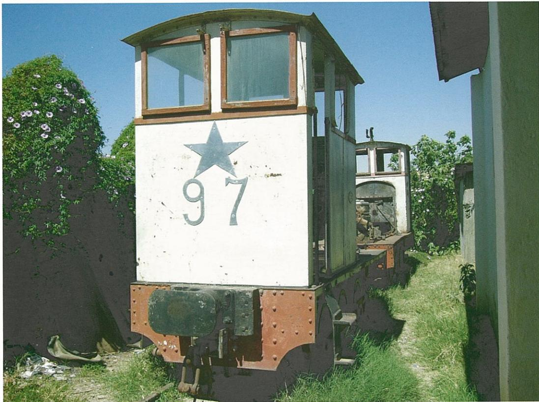
*Diesel inglese a tre assi con motore gardner*
